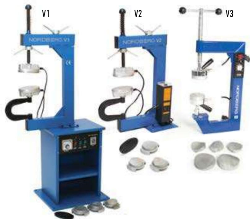
**Особенности:** Два нагревательных элемента для быстрой и надежной вулканизации; Фиксируемая поворотная консоль с верхней нагревательной головкой; Зажимное приспособление верхней головки позволяет легко и быстро производить вулканизацию путем соединения под давлением посредством подпружиненного винтового зажима; Электронный температурный контроллер предотвращает повреждение шины, которое может быть вызвано перегревом;
