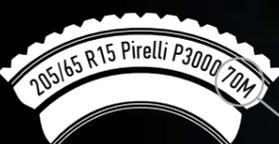
**205** — ШИРИНА ШИНЫ В ММ.
